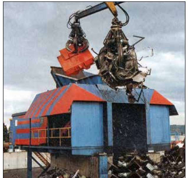
1992 - CFF S. PIERRE DE CHANDIEU Il primo premacinatore bialbero ad alberi controrotanti indipendenti.
